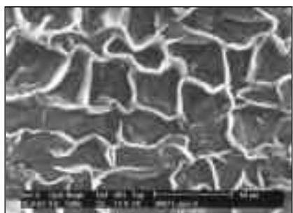
Fig 4 : bouchon en liège ciré
