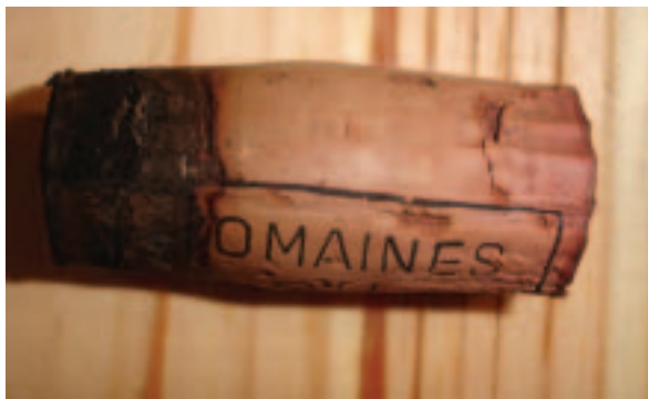
Cette photo, d'un autre bouchon indique un accident de stockage très net, très proche de celui de 1915. Il n'a pas empêché la saine tenue du liège, bien élastique.
