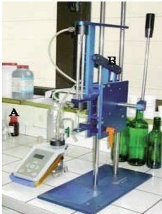
Figure 1 : Matériel de dosage de l'oxygène dissous dans les vins en bouteille.
