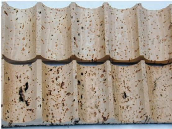
Variation de la porosité dans une planche de liège après ponçage de bouchons
